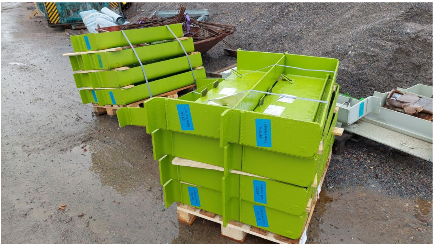
Nämäkin Petra-laattakanneet ovat uusiokäytetystä teräksestä valmistettu.
